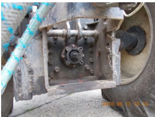
A mezőgazdasági erőgép teljesítmény-leadó tengelyvég burkolata hiányzott
