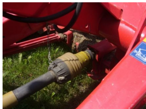
Traktorok kardántengelyei szabályos védőburkolattal ellátva
