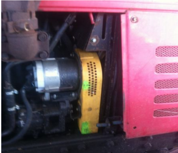
Mezőgazdasági erőgép generátor ékszíjhajtása védőburkolattal ellátva
