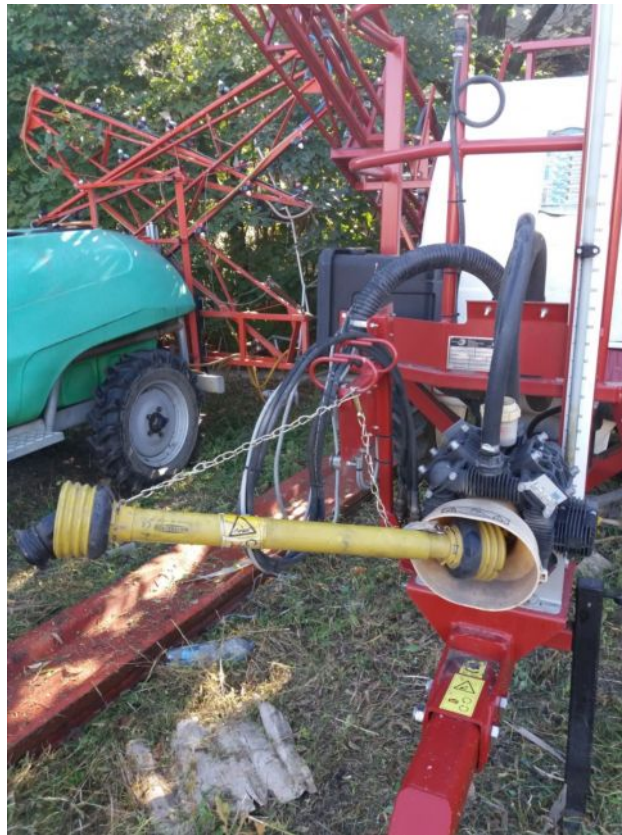
Permetezőgép kardántengelye szabályos védőburkolattal ellátva
