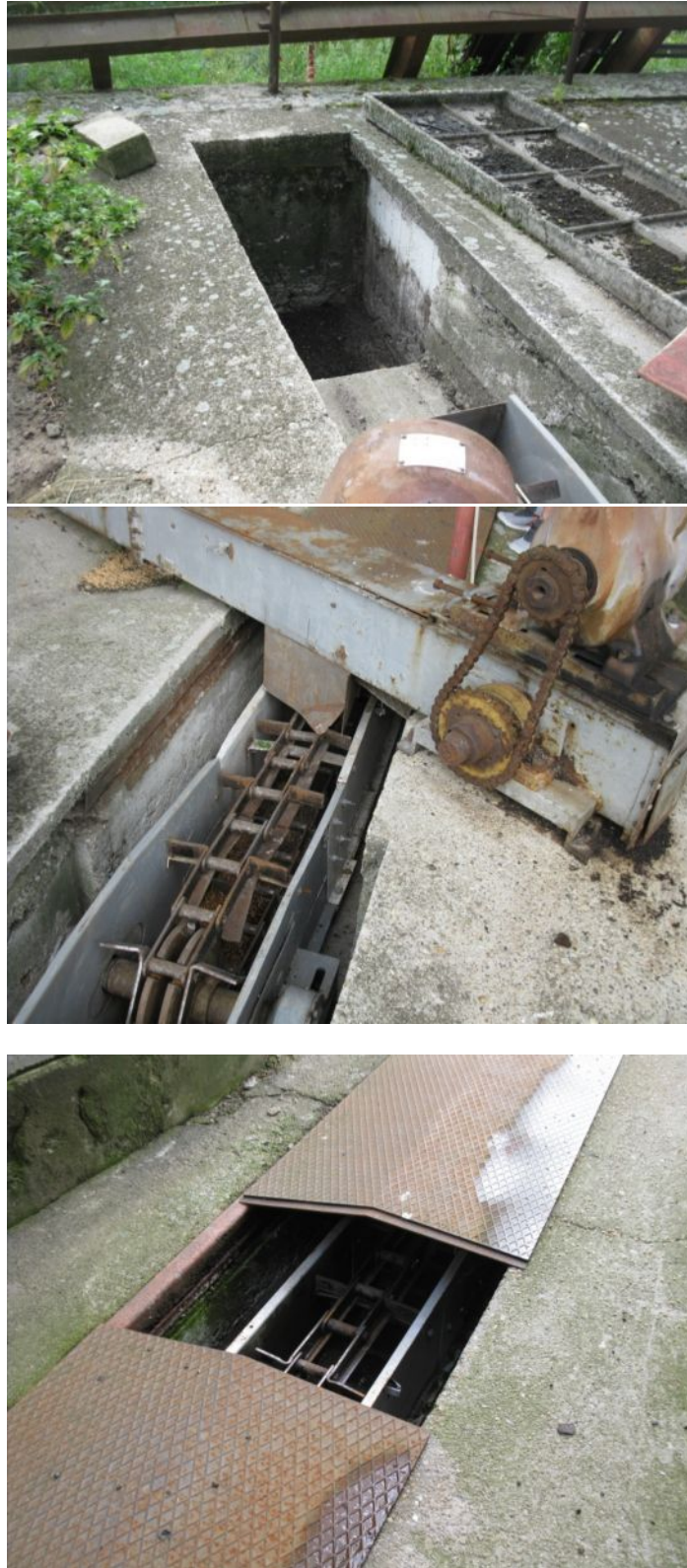
A gabonaszállító vonszolólánc aknájáról eltávolították a beton fedelet, a vonszolóláncot fedő lemezburkolat hiányos. A vonszolólánc működését villanymotor biztosította láncajtással, amelynek a teljes védőburkolata hiányzott.
