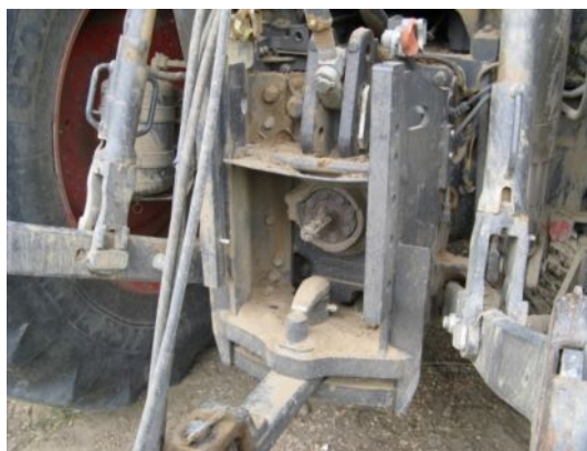
A mezőgazdasági erőgép teljesítmény-leadó tengelyvég burkolata hiányzott
