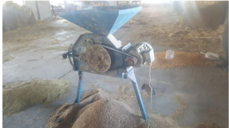
Terménydaráló meghajtását biztosító ékszíj és ékszíjtárcsák nem rendelkeztek védőburkolattal
