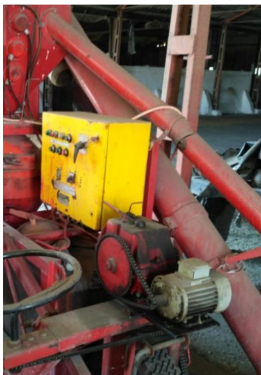
Csávázógép villanymotor lánchajtását nem fedi védőburkolat
