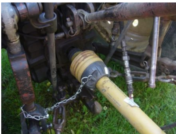
Traktorok kardántengelyei szabályos védőburkolattal ellátva
