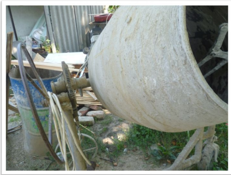
Védőburkolat hiánya betonkeverő gépen
